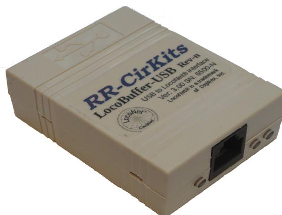
Dieser Buffer enthält leider keine Konstantstromquelle mehr. Ein Betrieb ist nur zusammen mit unserem LN-ES/VT oder mit dem Selbstbau einer 15 mA Konstantstromquelle möglich. Bild 3 zeigt das Schaltbild einer derartigen Stromquelle. Weitere findet man im Internet.
